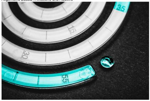
Die Fließspirale zeigt: Der gefärbte zusätzliche Fließweg wurde durch Zugabe des Additivs erreicht (Bild: Polytives).
