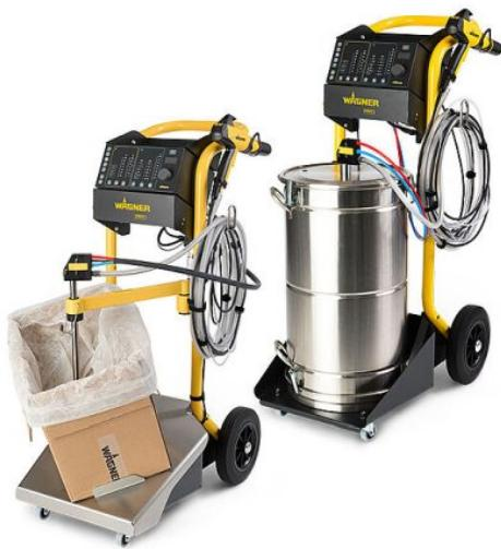
Die Pulver-Handanlage ist in zwei Varianten erhältlich: für die Pulverförderung direkt aus dem Originalkarton oder alternativ aus einem 60-l-Behälter. Umbauten zwischen den beiden Varianten sind möglich (Bild: Wagner).
