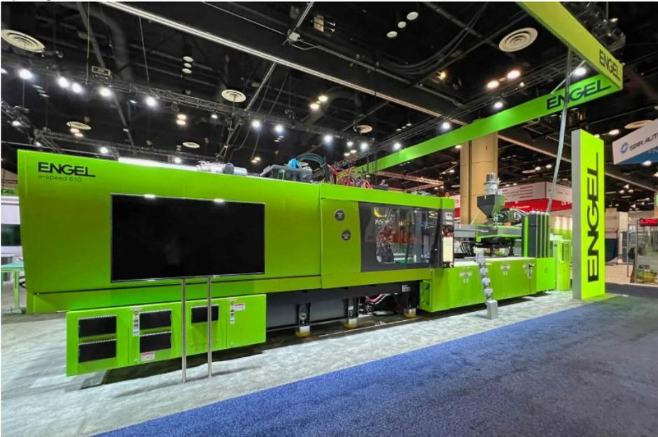
Diese Spritzgießmaschine produzierte auf der Messe NPE 2024 manipulationssichere Lebensmittelbehälter mit In-Mold-Labeling (Bild: Engel).
