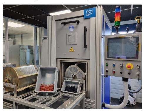
Mit der neuen Plasmabeschichtung entstehen z. B. hydrophile oder hydrophobe Oberflächen (Bild: OVE).
