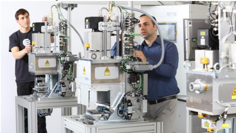
Laserschweiß-Prozessmodul zur Integration in Montagelinien (Bild: Evosys).
