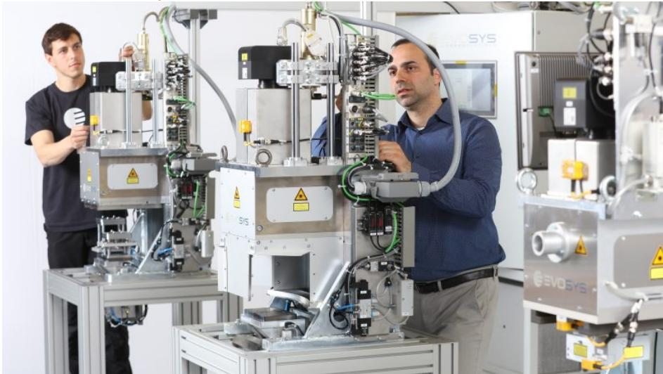
Laserschweiß-Prozessmodul zur Integration in Montagelinien (Bild: Evosys).
