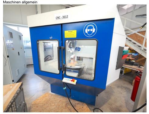
Die 5-Achs-CNC-Rundtischsräsmaschine setzt swissplast z. B. für kleine Werkstücke ein (Bild: HG Grimme Systech).
