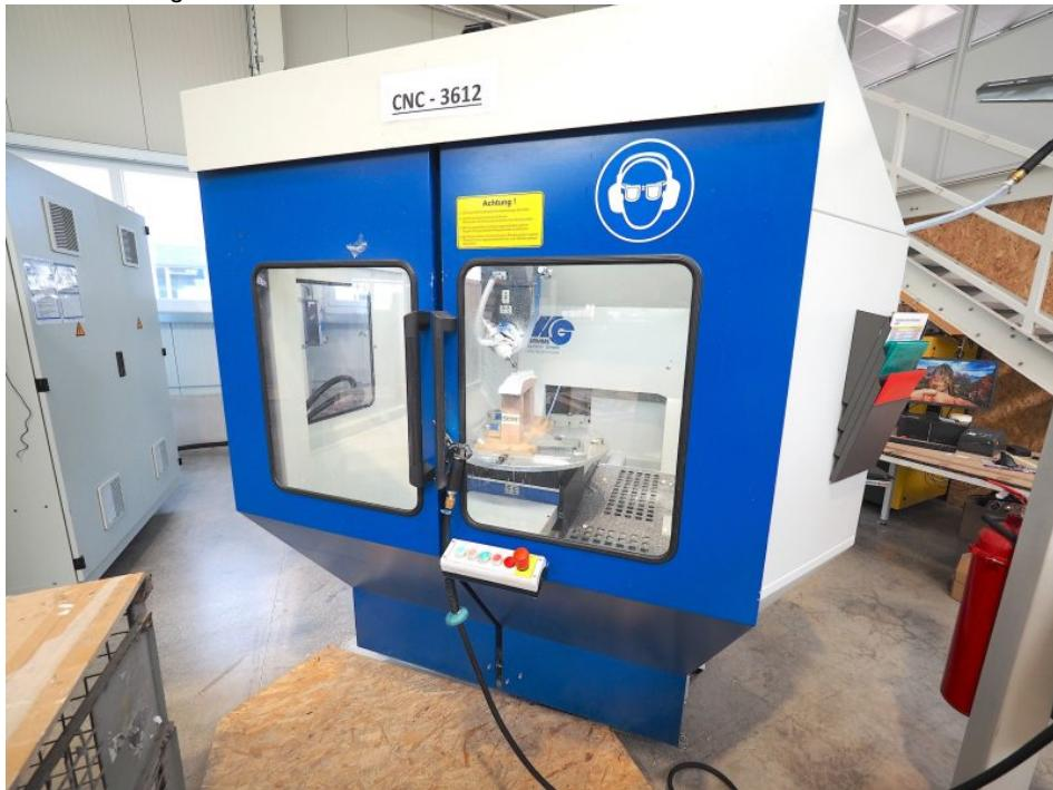
Die 5-Achs-CNC-Rundtischsräsmaschine setzt swissplast z. B. für kleine Werkstücke ein (Bild: HG Grimme Systech).
