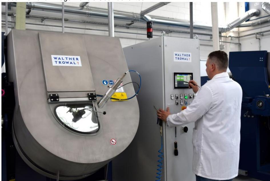
Mithilfe der Beschichtungsmaschinen und neuer Gleitlacke ist eine PFAS-freie Beschichtung z. B. von O-Ringen möglich (Bild: Walther).
