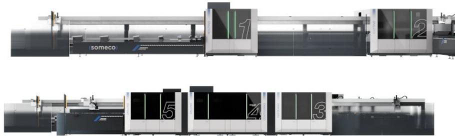
Oben Linie 1, bestehend aus einem PVC-Bearbeitungs- und Sägemodul, unten Linie 2, bestehend aus der Schraubstation und Stationen zur Folgebearbeitung von Profilen mit Stahlverstärkung (Bilder: Elumatec).
