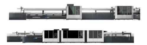
Oben Linie 1, bestehend aus einem PVC-Bearbeitungs- und Sägemodul, unten Linie 2, bestehend aus der Schraubstation und Stationen zur Folgebearbeitung von Profilen mit Stahlverstärkung (Bilder: Elumatec).
