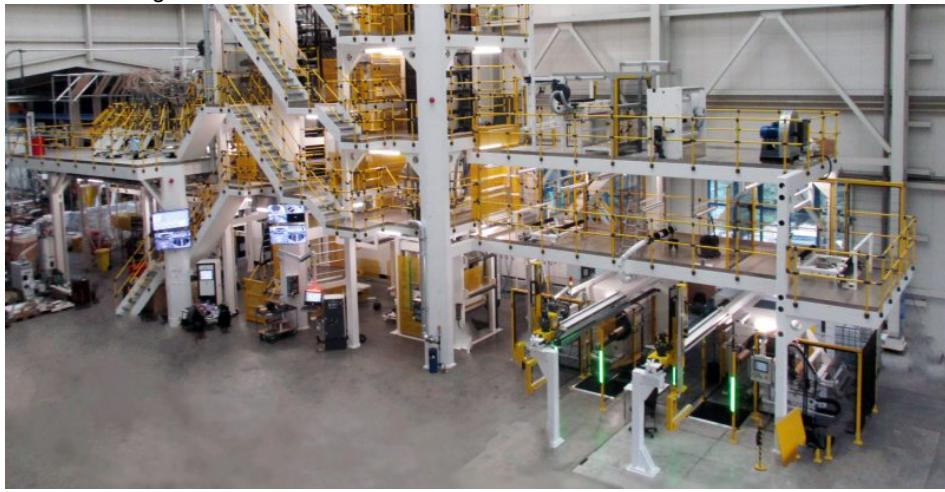
Mittelgroße Blasfolienanlagen erreichen Durchsätze bis zu 250 kg/h bei der Herstellung von Folien für recyclinggerechte Barriere-Schrumpfbeutel (Bild: Kuhne Anlagenbau).
