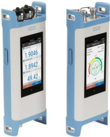
Die Handheld-Ladungsverstärker ermöglichen es Anwendern von piezoelektrischen Sensoren, direkt vor Ort Prozessparameter zu überprüfen und Qualitätskontrollen durchzuführen (Bild: Kistler).
