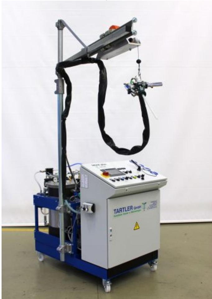
Die Dosier- und Mischanlage wurde für mittlere und kleine Mengen entwickelt (Bild: Tartler).
