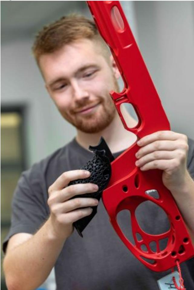
Griffstück und Mittelhandstütze des Biathlon-Gewehrschaftes sind als leichte Wechselelemente in Lattice-Struktur ausgeführt (Bild: FKM).
