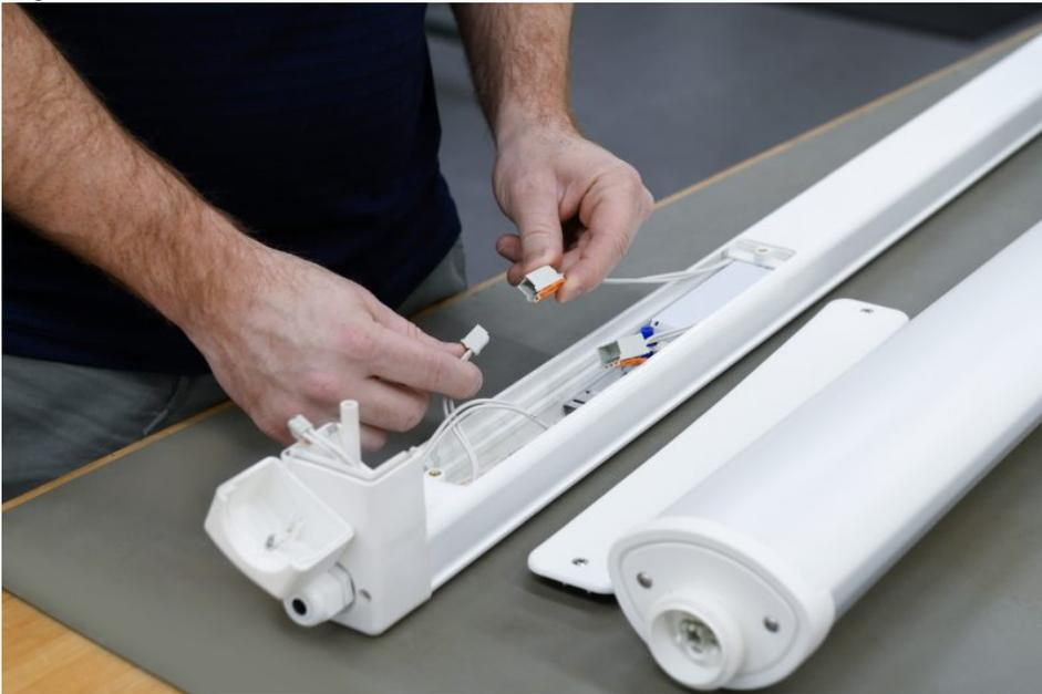
Nachhaltig: Sowohl der Austausch des Betriebsgeräts bei Leuchten als auch der Wechsel der LEDs ist einfach möglich (Bild: Norka).
