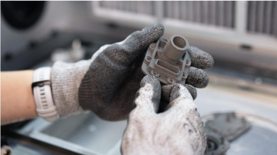
Wenn Präzision und Oberflächengüte zählen fertigt IMT Bauteile mit dem SLS-3D-Drucker (Bild: Sintratec).
