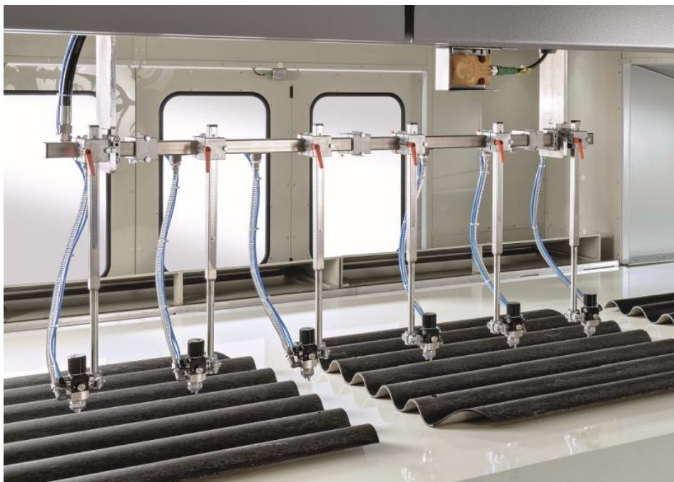
Blick in Spritzlackieranlage zur Beschichtung von Bauelementen (Bild: Venjakob).
