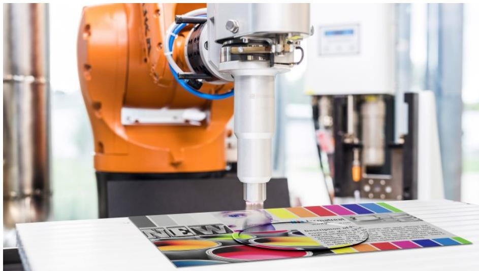
Nach der Feinstreinigung mit Plasma können Metalle oder Glas mit UV-Farben bedruckt oder lackiert werden (Bild: Plasmatreat).
