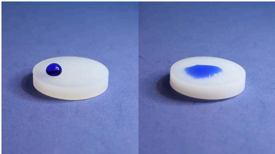
Im Bild links wurde das Kunststoffsubstrat mit dem neuen Plasmaverfahren behandelt und ist nun wasserabweisend, rechts ein unbehandeltes Substrat (Bilder: INP).
