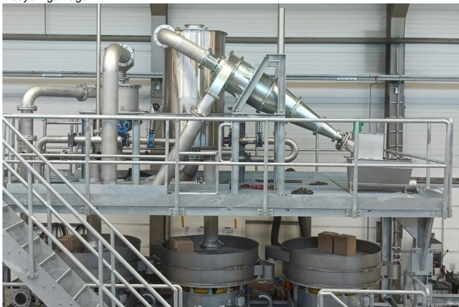
Auch die Hydrozyklonstufe der PET-Recycling-Linie ist für eine Leistung von 100 t am Tag ausgelegt (Bild: Herbold Meckesheim).
