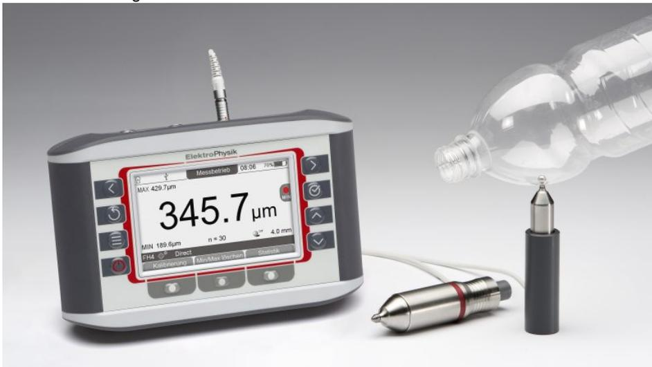
Das Wanddicken-Messgerät erlaubt die Messung von NE Werkstoffen bis zu 24 mm Wanddicke (Bild: Elektrophysik).
